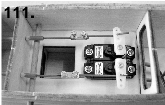
111. Einbau der Servos und der Ruderanlenkung.
